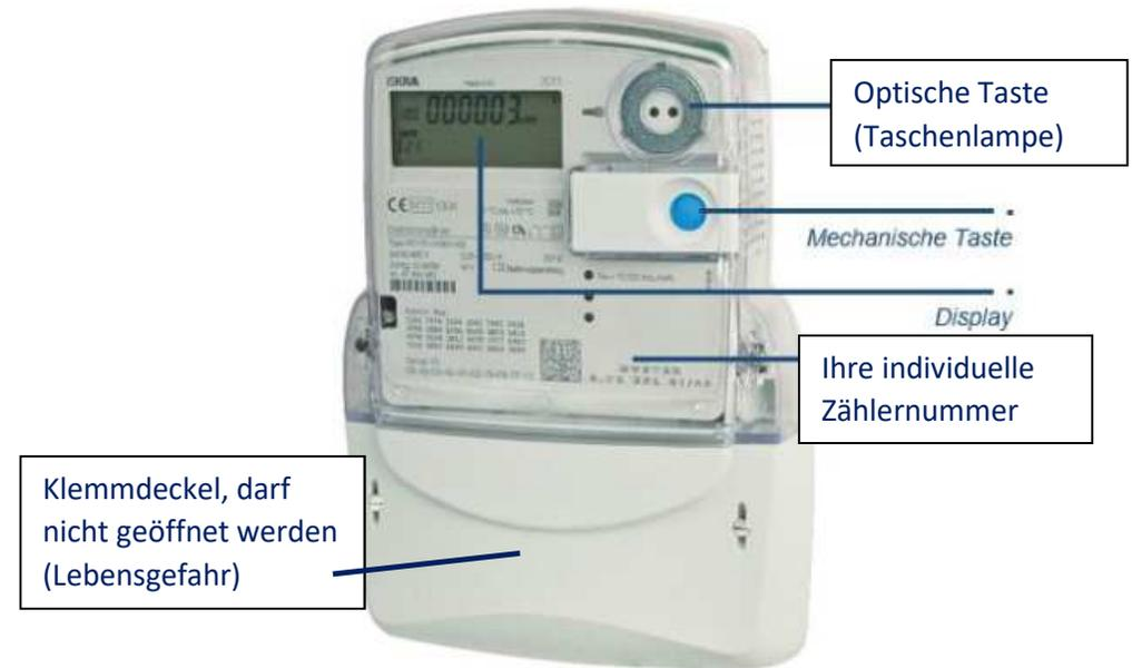
Das Display zeigt im Normalzustand den **abrechnungsrelevanten Zählerstand** an. Die Verbrauchsdaten sind durch einen **vierstelligen PIN** geschützt und können manuell durch die optische Schnittstelle mithilfe einer handelsüblichen **Taschenlampe** ausgelesen werden.
