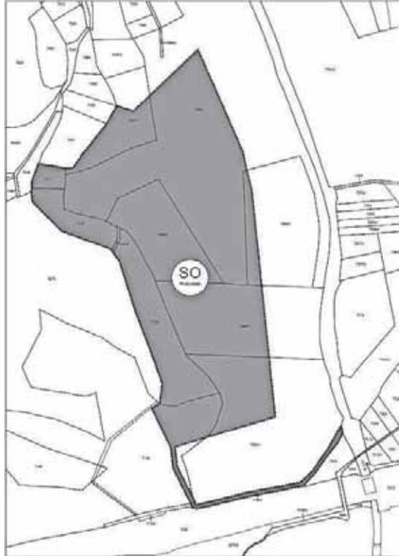
Gegenstand des Verfahrens ist die Schaffung von Planungsrecht für die Errichtung einer Anlage zur Erzeugung von Strom aus Photovoltaik in Freilandaufstellung. Die Anlage besteht aus geständerten Solarmodulen mit der entsprechenden Unterkonstruktion, den notwendigen technischen Bauten (Übergabestation), einem Zaun sowie befestigten (aufgeschotterten) Wegeflächen.
